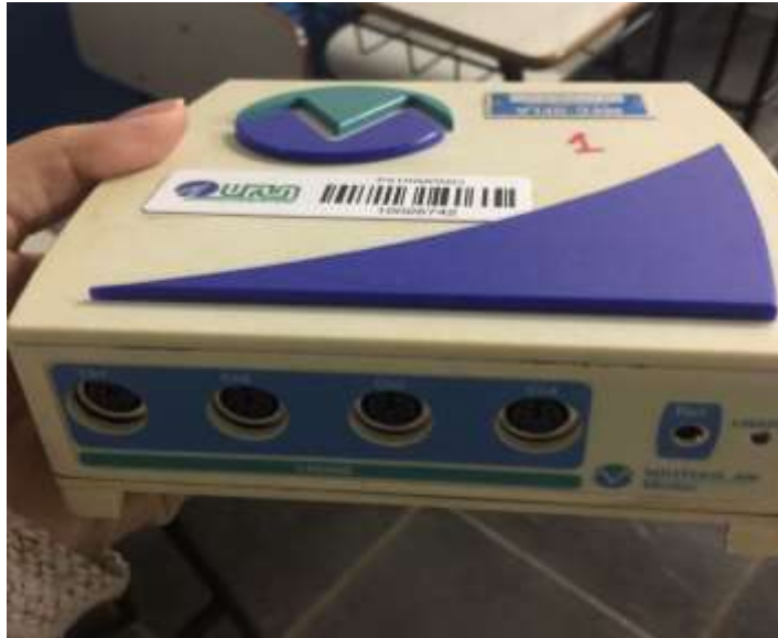
Figura 1 - Eletromiógrafo Miotol 400 usado para a realização da coleta de dados.
