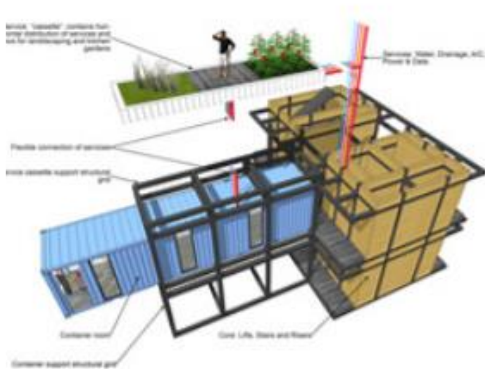
Imagem 06: Esquema estrutural container/grid/estrutura central
