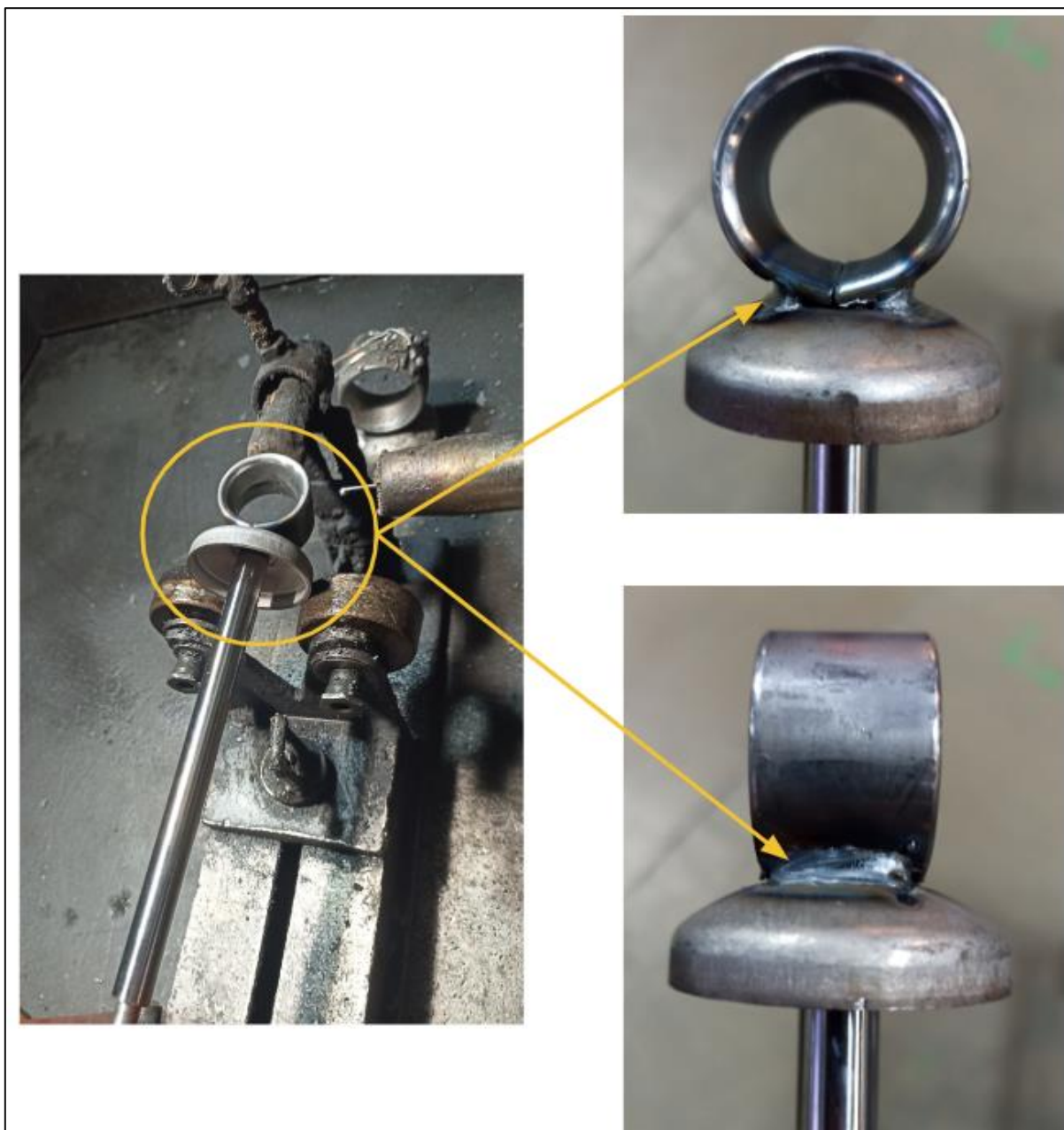
Figura 5: Processo de solda reforço dos conjuntos.
