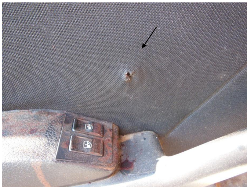
Figura 58 - Mossa na porta interna esquerda.
