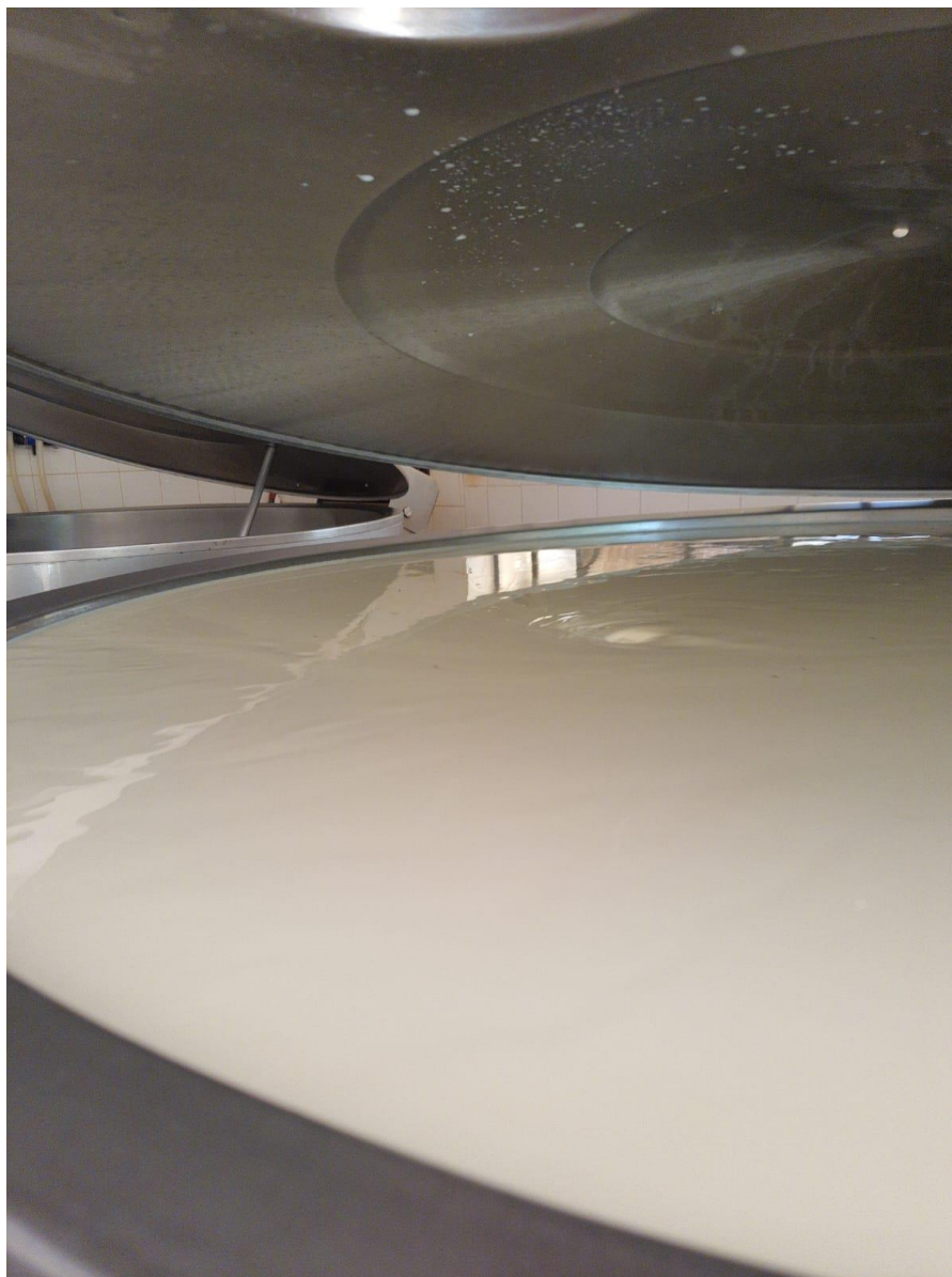
Imagem 4: Tanque de expansão.
