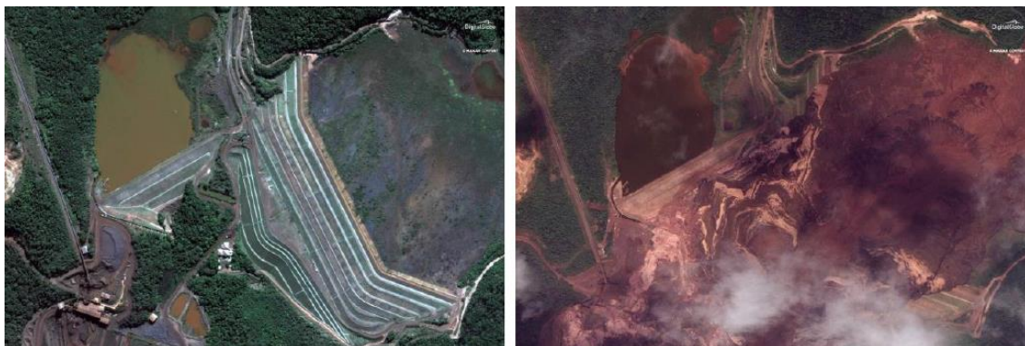
Figura 6 - Barragem Córrego do Feijão em Brumadinho, antes e depois do rompimento.
