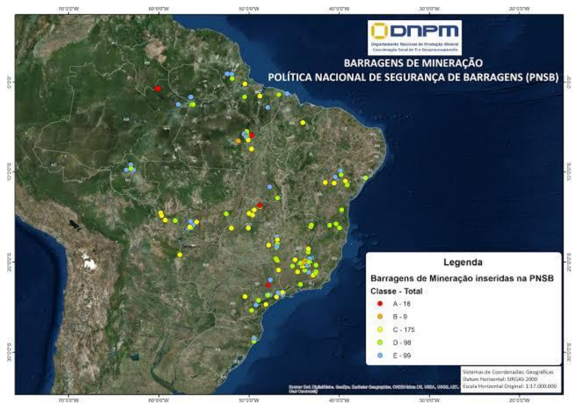
Figura 8 - Mapa com as localizações das barragens de rejeitos no Brasil, distribuída conforme o Dano Potencial Associado (DPA).
