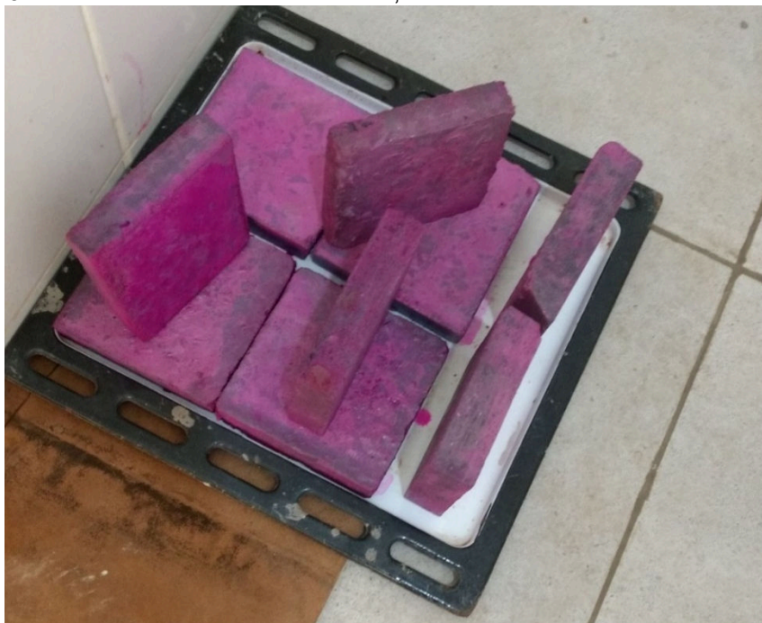
Figura 15 – Placas de concreto sendo secas, no clima de laboratório
