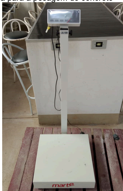
Figura 6 – Balança utilizada para a pesagem do concreto
