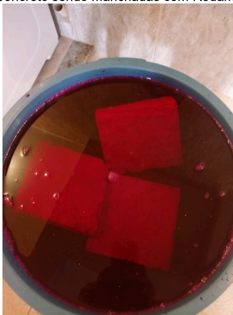
Figura 13 – Placas de Concreto sendo manchadas com Rodamina B
