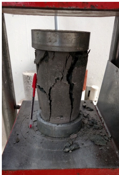
Figura 10 – Corpo de prova rompido pela prensa hidráulica
