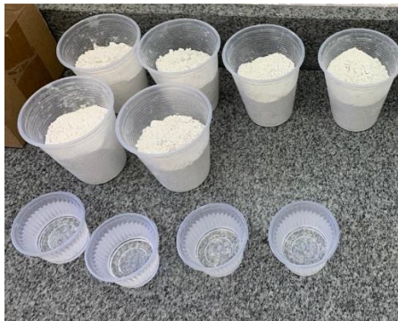
Figura 9 – Copos descartáveis separando as dosagens corretas de gesso e água para vazarem os moldes.
