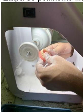
Figura 22 – Etapa de polimento final em torno.
