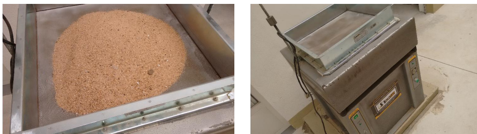
Figura 3 – Peneiramento da areia média para fina e agitador elétrico de peneiras quadradas
