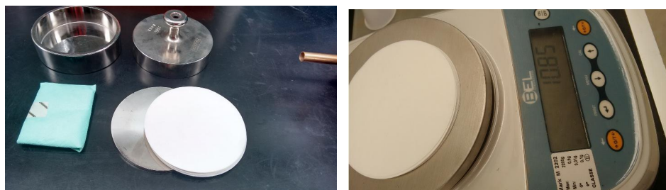
Figura 9 – Molde cilíndrico, demais equipamentos para o ensaio e pesagem dos discos de papel-filtro
