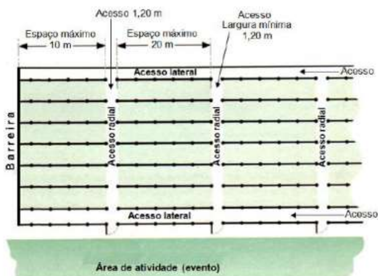
Figura 14 – Medidas Preventivas para Arquibancada.
