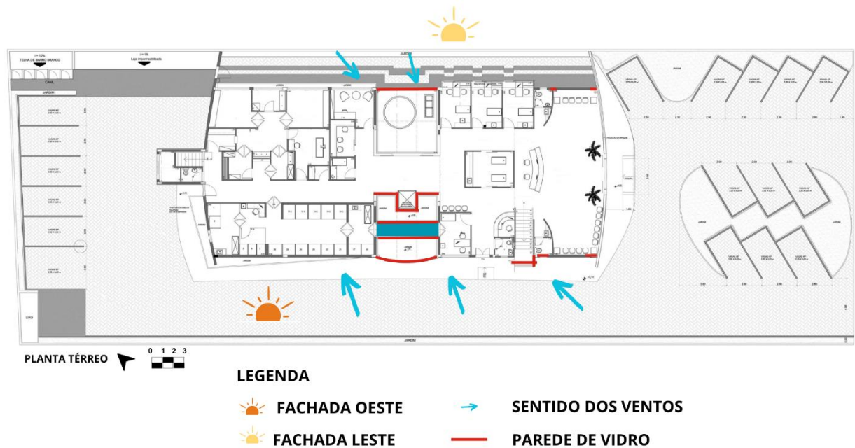
Figura 11: Soluções de Conforto Ambiental
