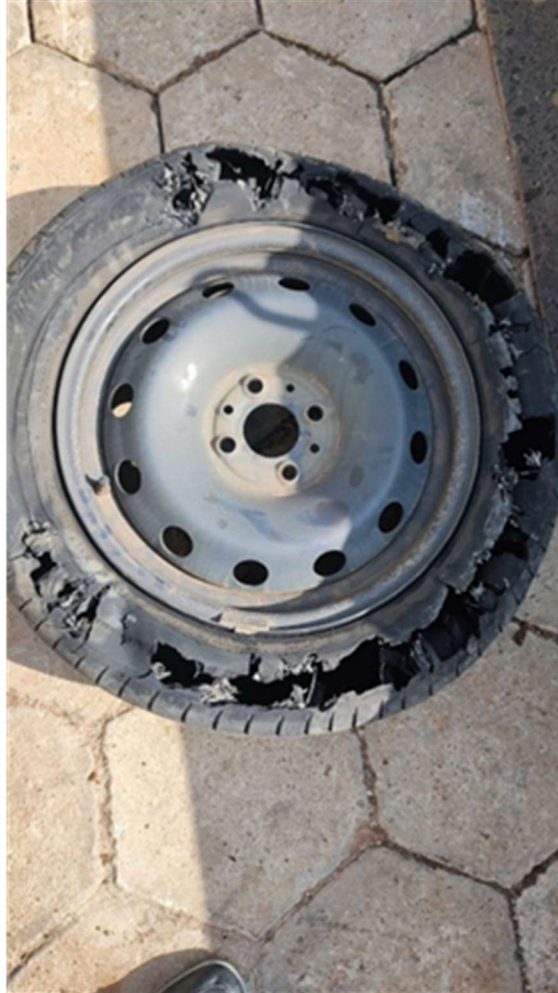
Figura 16 - Pneu danificado em decorrência de um buraco encontrado na rodovia.
