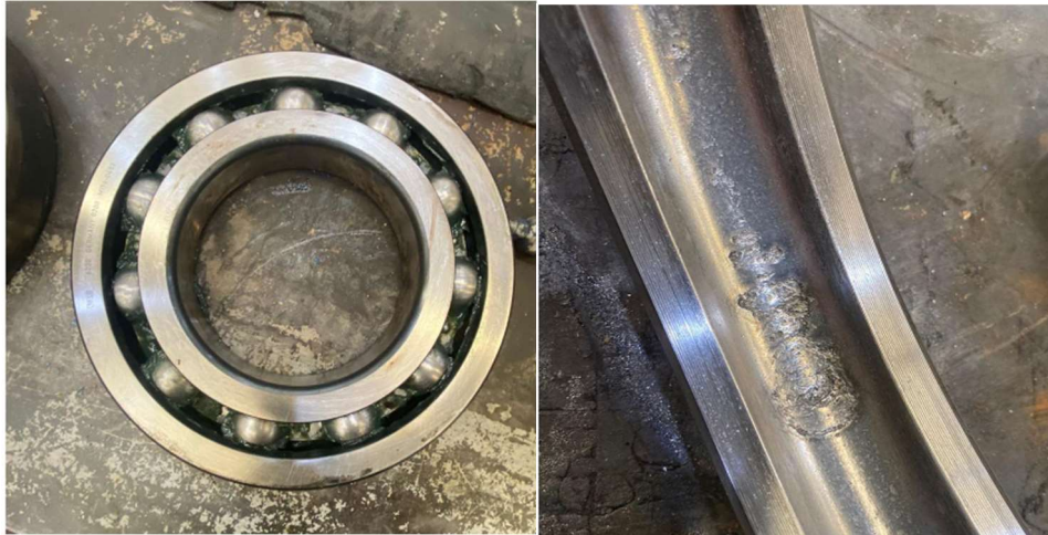
Figura 40 - Marcas de pitch na pista externa do rolamento.
