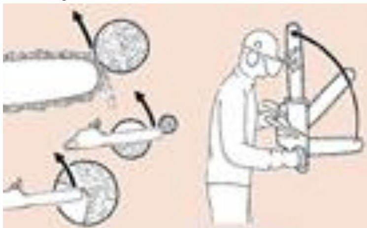
Figura 2 - Rebote da motosserra (kick-back)
