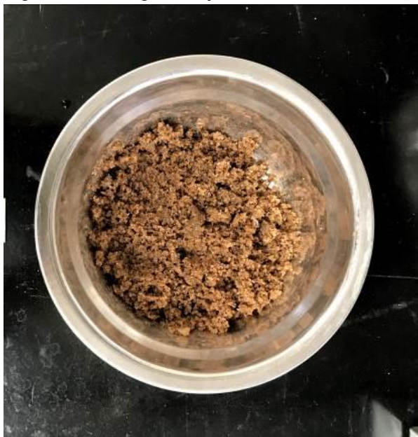
Figura 7 - Homogeneização da amostra de areia fina
