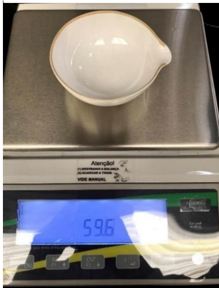
Figura 21 - Pesagem do cadinho vazio
