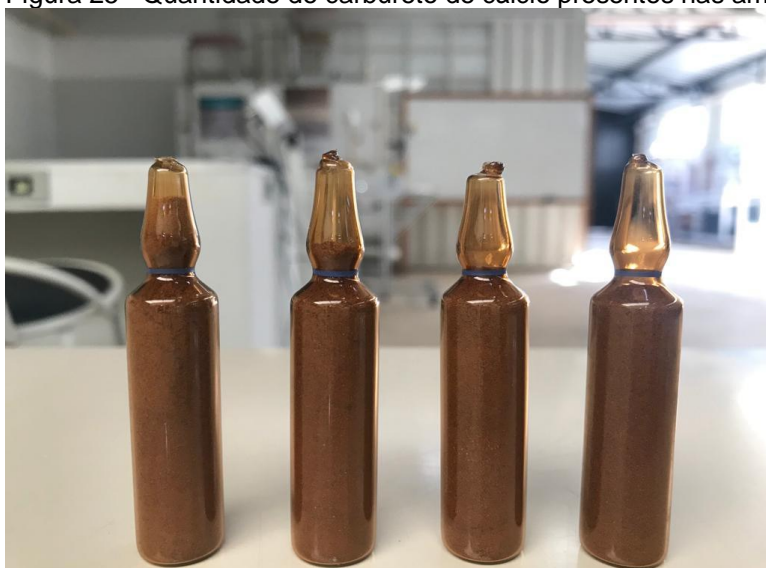
Figura 25 - Quantidade de carbureto de cálcio presentes nas ampolas
