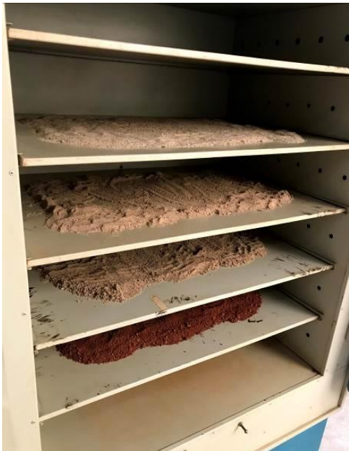
Figura 4 - Secagem em estufa das amostras de solo e areias
