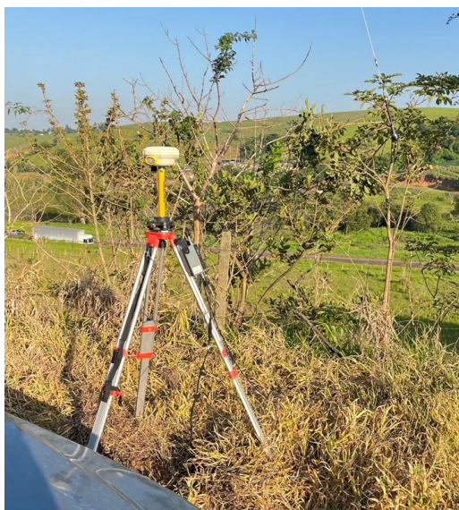
Figura 71 - Equipamento de topografia GPS RTK
