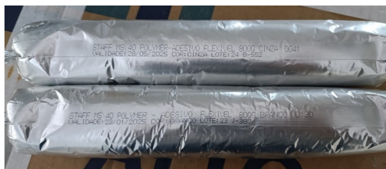
Figura 107 - Mastique cinza e branco utilizados na fachada
