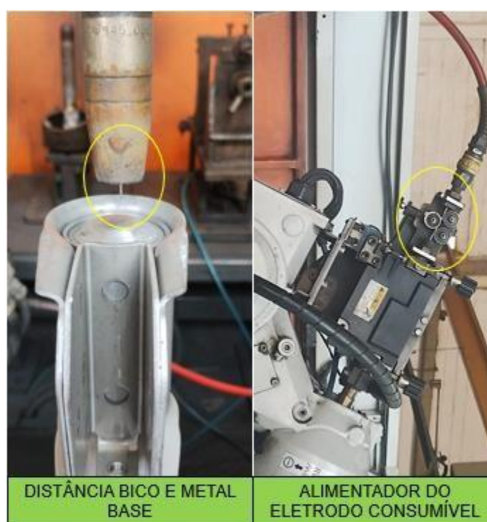
Figura 18 Distância Entre o Bico de Solda e Metal Base e Alimentador do Eletrodo.
