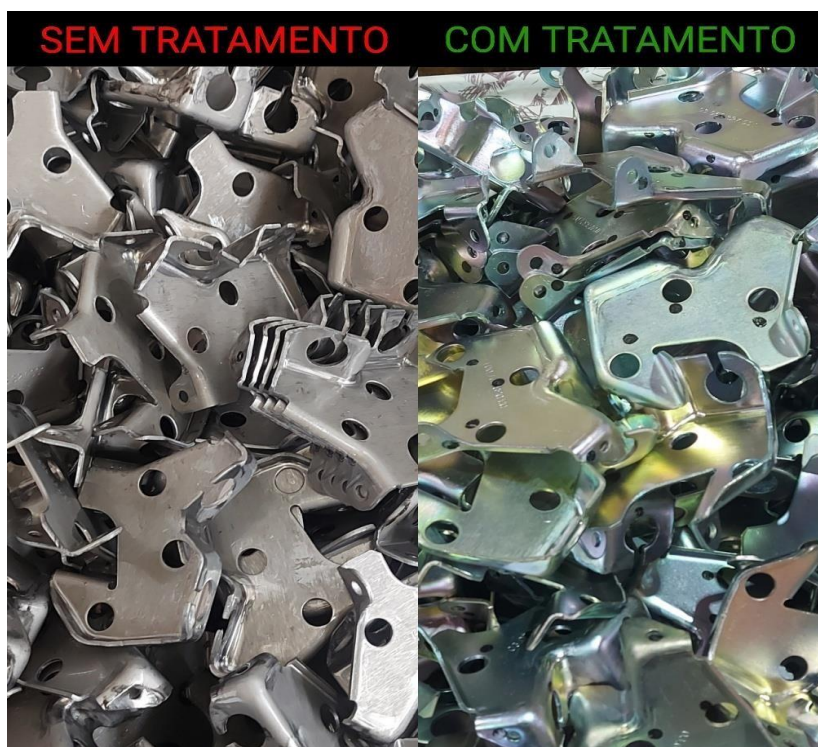
Figura 5 Peças com e sem tratamento de zinco — setembro/2024
