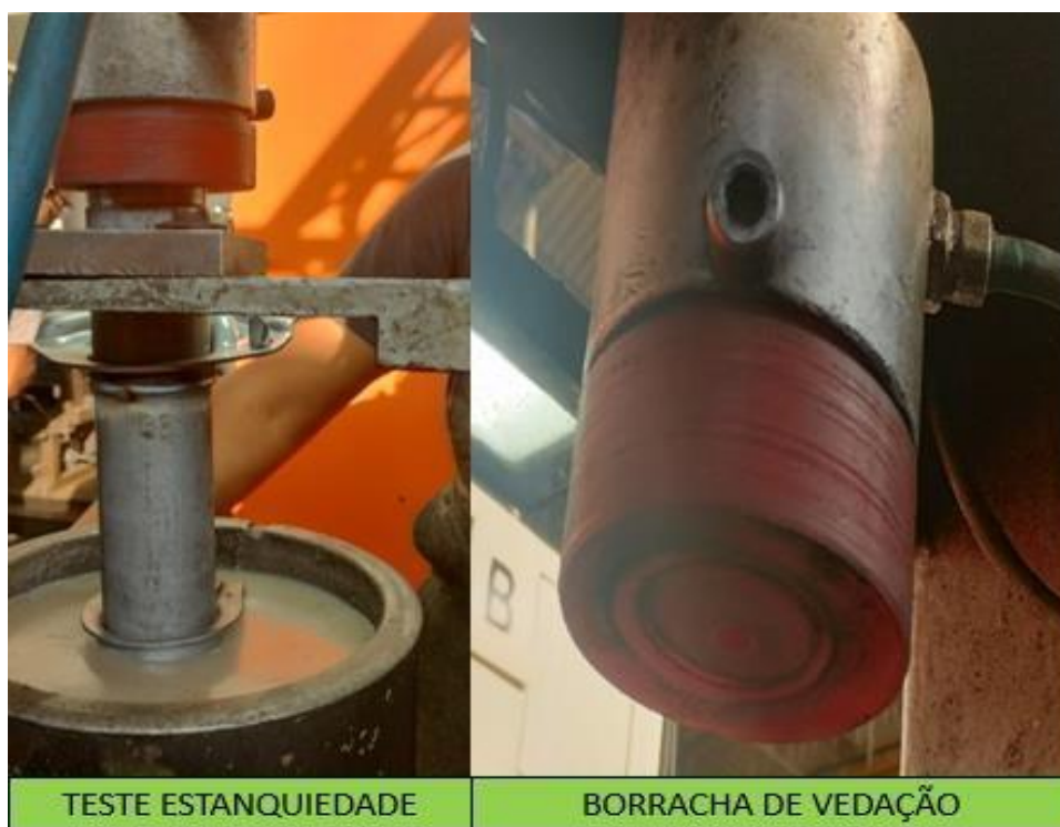
Figura 19 Teste Estanqueidade e borracha de Vedação.
