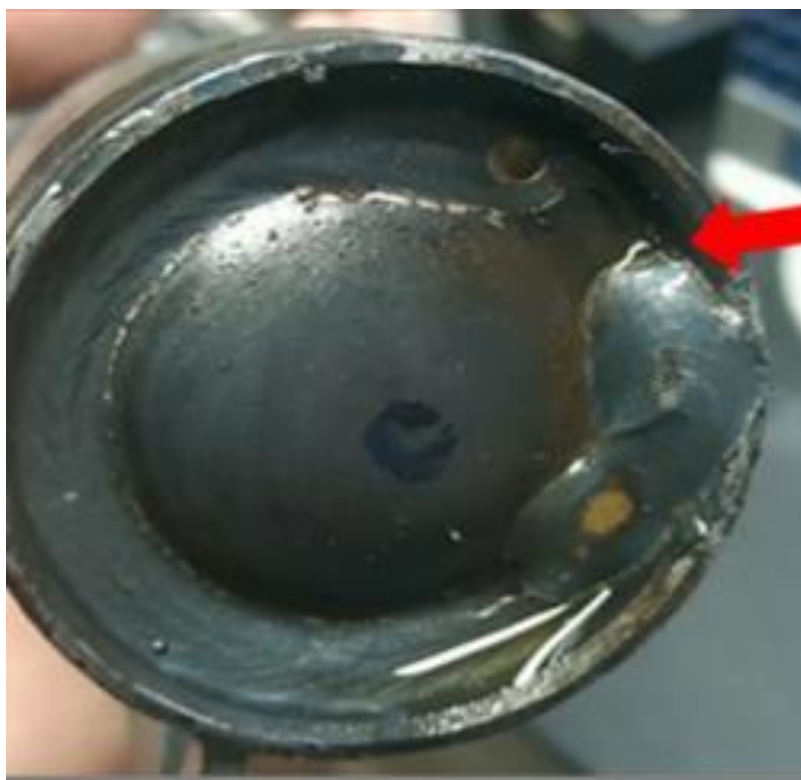
Figura 12 Vazamento na Solda na Região do Copo da Base.
