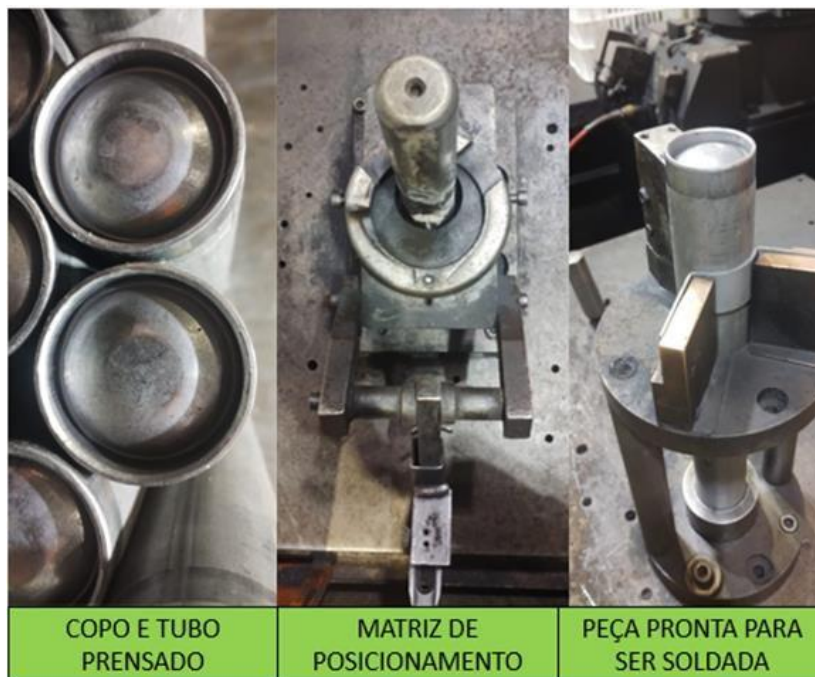
Figura 15 Processo de posicionamento da Ferragem Antes da Solda.
