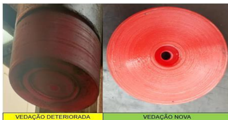
Figura 23 Substituição da Borracha de Vedação.
