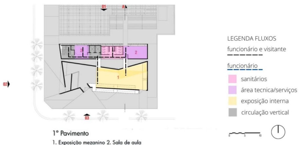
Figura 6 – Planta primeiro pavimento - Espaço Cultural Porto Seguro
