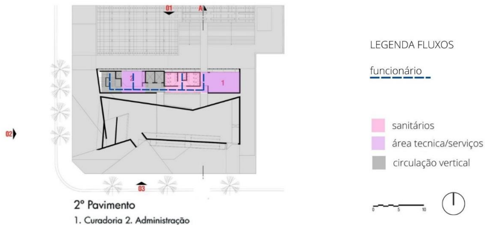
Figura 7 – Planta segundo pavimento - Espaço Cultural Porto Seguro
