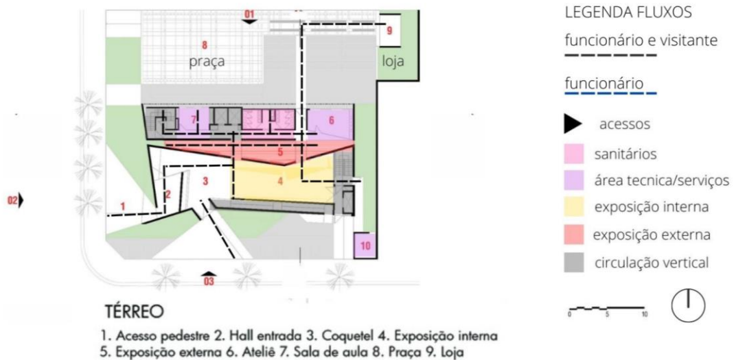
Figura 5 – Planta pavimento térreo - Espaço Cultural Porto Seguro
