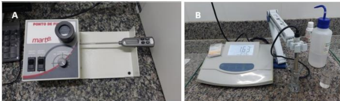
Figura 12- Equipamentos utilizados na farmácia magistral para a determinação de parâmetros físico-químicos. A. Equipamento para verificação do ponto de fusão dos insumos. B. Phmetro utilizado no controle de qualidade de matérias-primas para a avaliação do pH.
