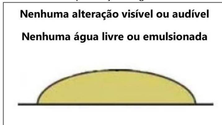
Figura 67 - Nenhuma presença de água livre ou emulsionada
