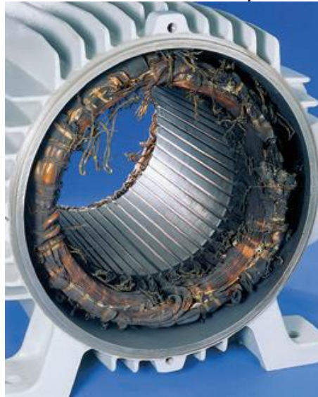
Figura 34 – Queima de motor elétrico por sobreaquecimento
