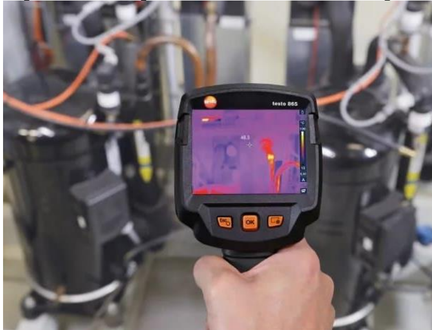
Figura 32 - Termógrafo Testo 865 em análise termográfica
