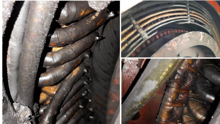
Figura 11 - Contaminação do bobinado por pó de escovas e óleo
