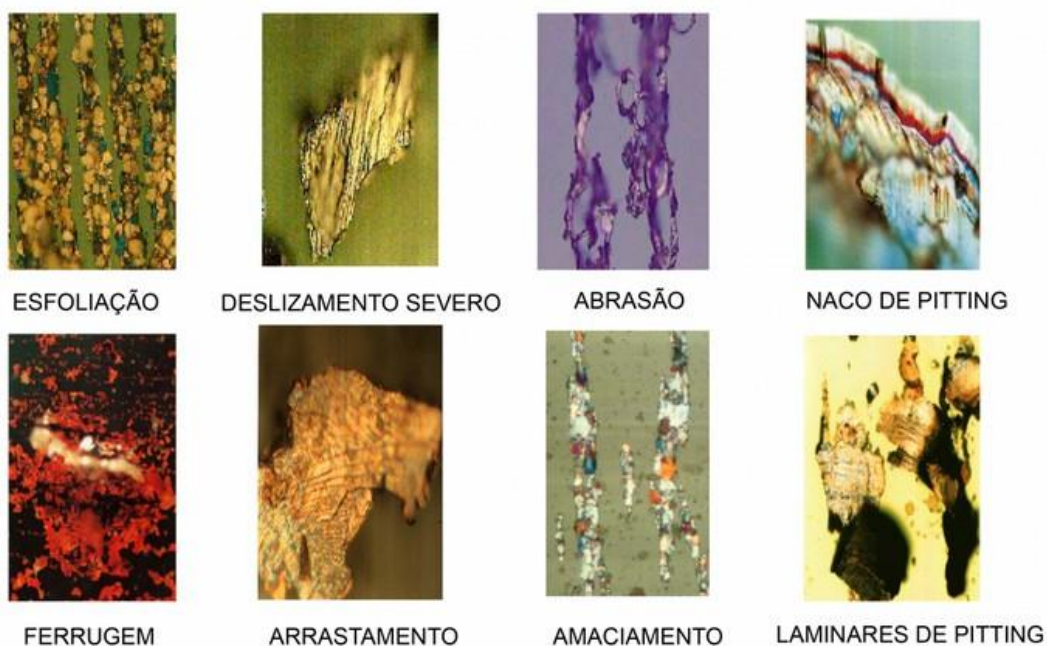
Figura 73 - exemplos de partículas vistas na análise de ferrografia
