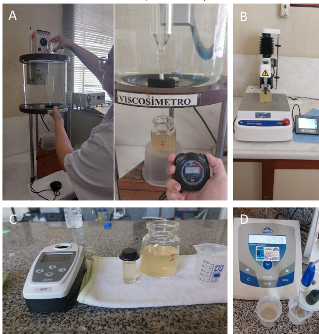
Figura 16- A: Análise de viscosidade; B: análise de força de gelificação (Bloom); C: análise de turbidez; D: análise de pH.
