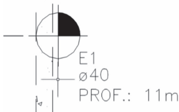
Figura 78 – Detalhe de um projeto de estacas
