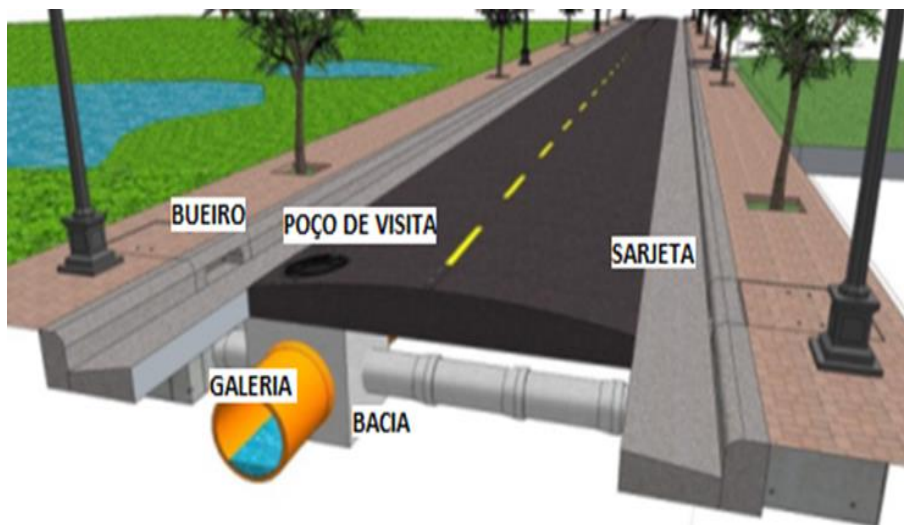
Figura 11 – Modelo de rede de drenagem pluvial
