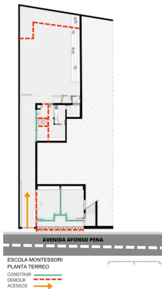
Figura 3: Planta baixa pavimento inferior – Demolir/Construir
