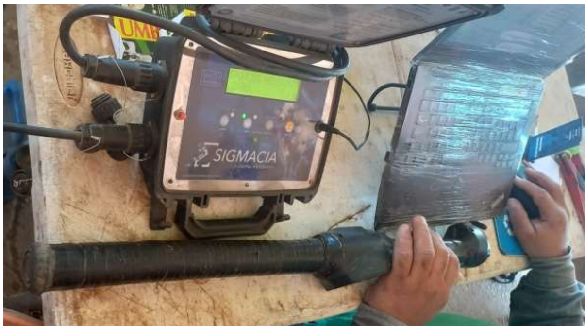
Figura 6 - A imagem mostra uma balança digital, um bastão de leitura para identificação dos animais e o computador para lançamentos do sistema.
