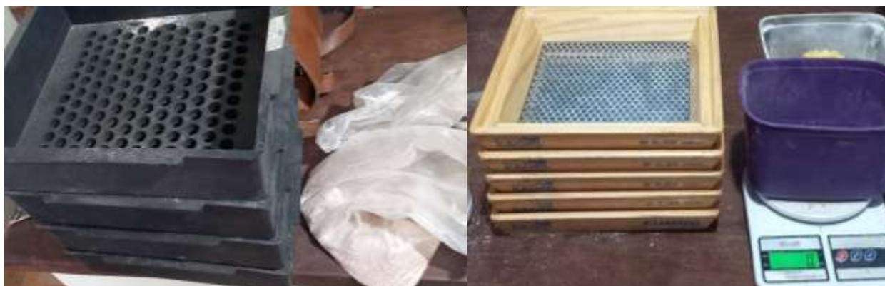
Figura 9 - Imagem a esquerda, conjunto de peneiras para análise de partículas maiores para silagem, imagem à direita um conjunto de peneiras para grãos menores que passaram por processo de moagem ou trituração, juntamente com balança digital para auxílio.
