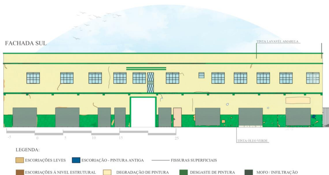
Figura 52 – Mapa de danos da fachada sul (fachada principal).
