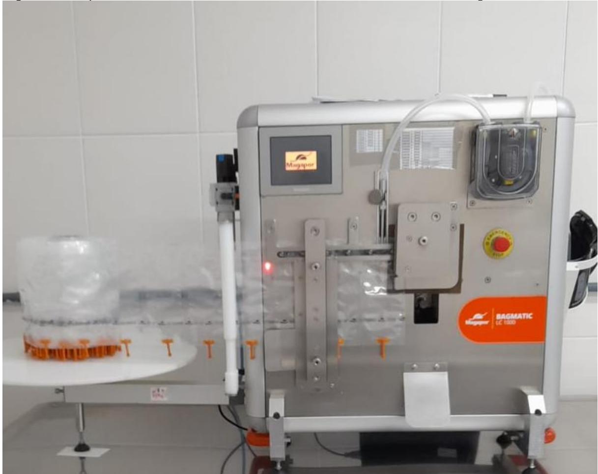
Figura 3: Máquina de envase das doses de sêmen da unidade de difusão genética.
