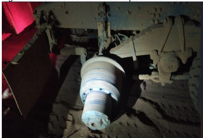
Figura 31 - Soltura do rodado sem quebra do eixo.
