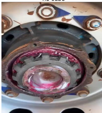
Figura 38 – Porca Castelada instalada no cubo
