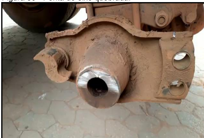
Figura 30 - Ponta do eixo quebrada.
