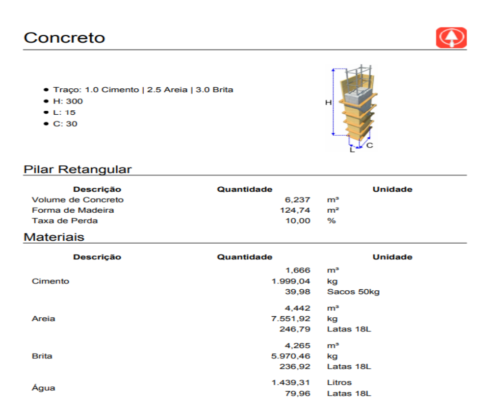
Figura 21 – Levantamento quantitativo Pilar no Construcalc
