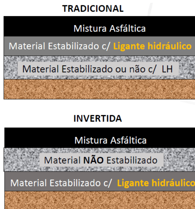
Figura 41 – Representação das camadas do pavimento semirrígidos
