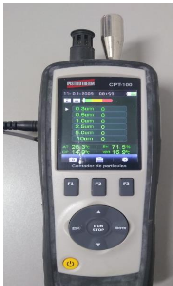
Figura 2 - Contador de Partículas com Câmeras do Modelo CPT-100
