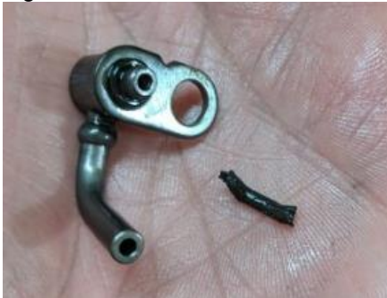
Figura 32 – Jet de óleo obstruído
