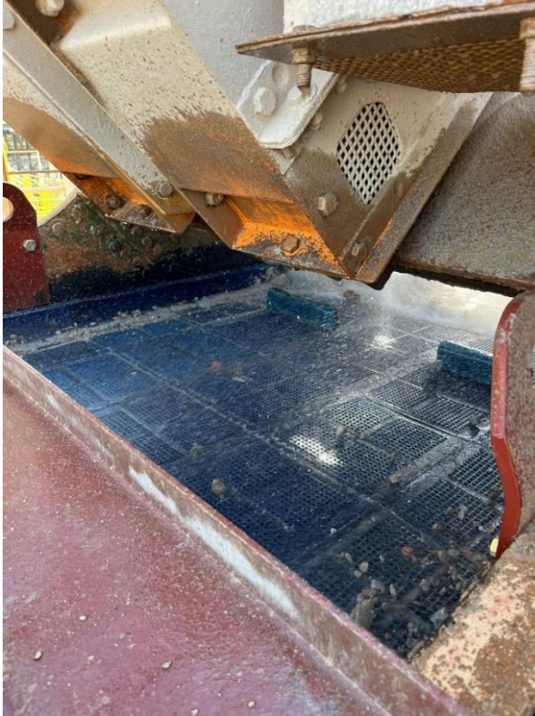
Figura 10 - Peneira vibratória e umidificadora
