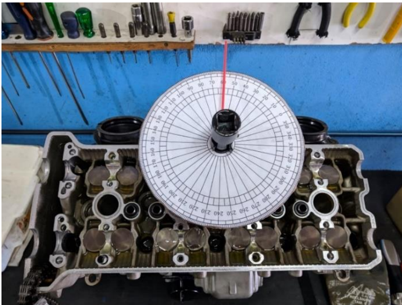
Figura 35 – Ferramenta posicionada para aplicar torque e a transferência de ângulo
