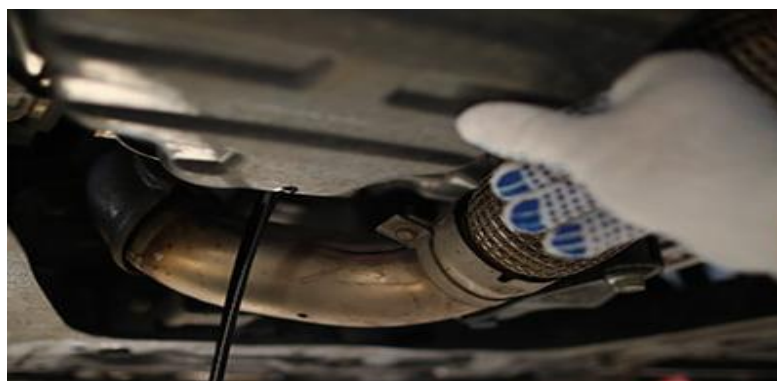
Figura 3 - Retirada de óleo do veículo para descontaminação
