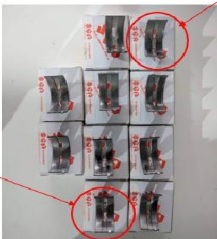
Figura 31 – Par de bronzinas fora da especificação.
