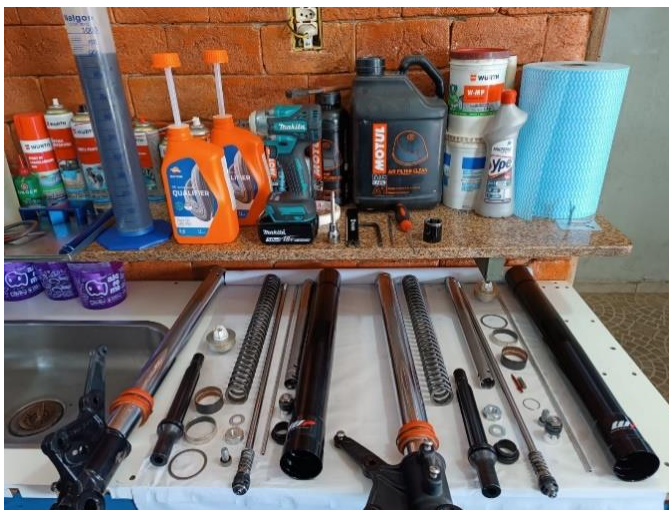
Figura 23 – Manutenção, limpeza e ajuste em suspensão
