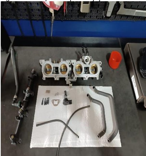
Figura 21 – Limpeza corpo de injeção
