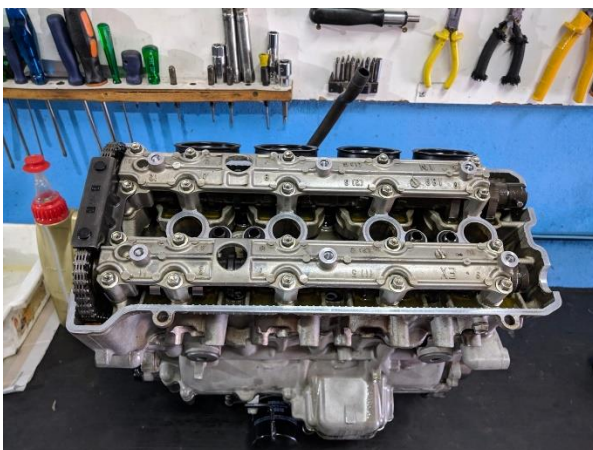
Figura 26 – Abertura da tampa de válvulas
