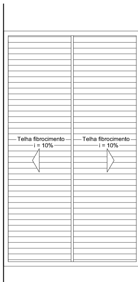
Figura 96 – Planta de cobertura
