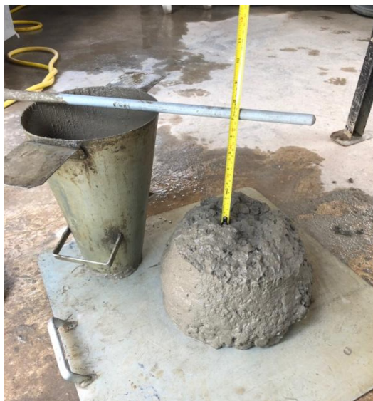
Figura 9 – Medição do abatimento
