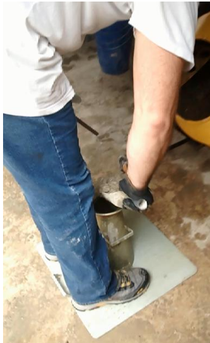
Figura 7 – Colocando a primeira camada de concreto no tronco de cone
