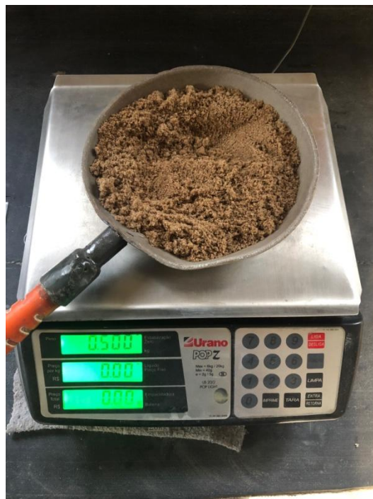
Figura 3 – Peso da areia úmida
