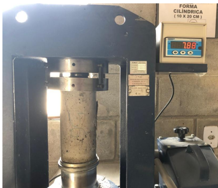
Figura 12 – Rompimento do corpo de prova
