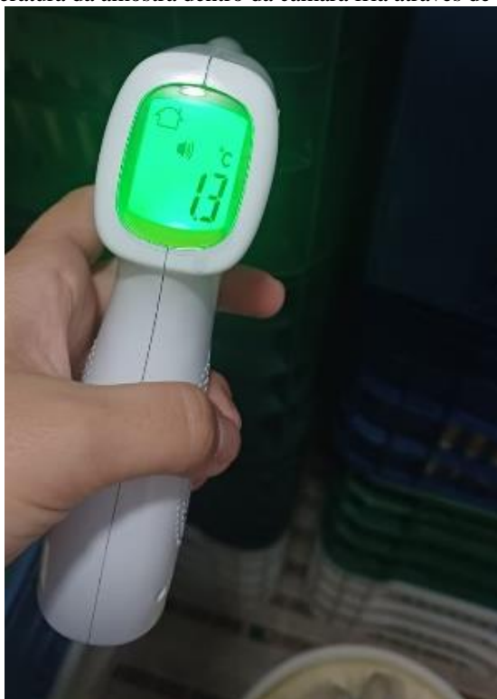
Figura 28: Aferição de temperatura da amostra dentro da câmara fria através de um termômetro de superfície.
