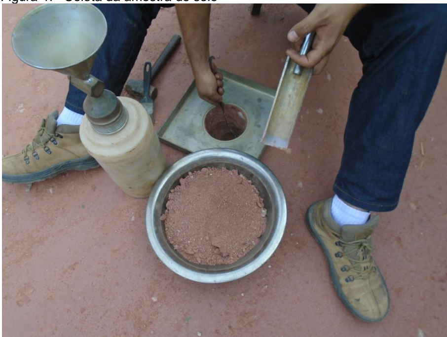
Figura 47- Coleta da amostra do solo
