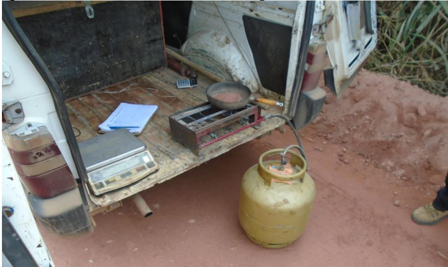
Figura 48- Laboratório móvel com teste da frigideira
