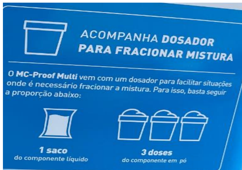
Figura 46 - Instruções para fracionamento da mistura.
