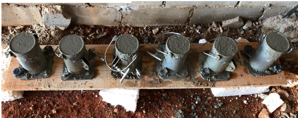
Figura 48: Corpos de prova moldados
