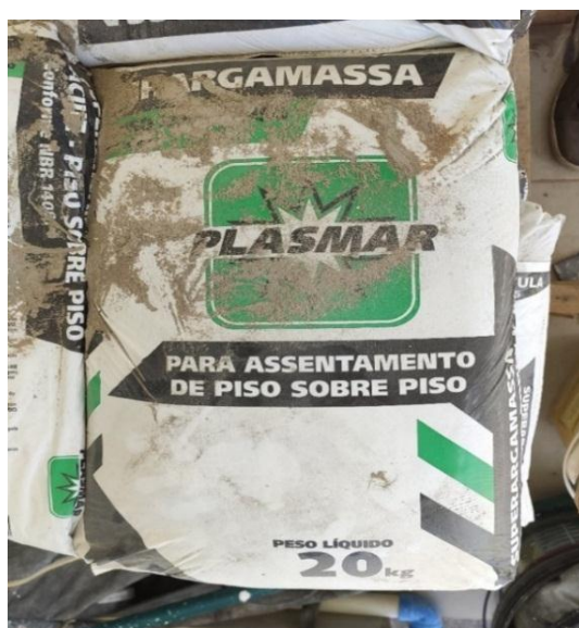
Figura 84: Argamassa Plasmар, piso sobre piso
