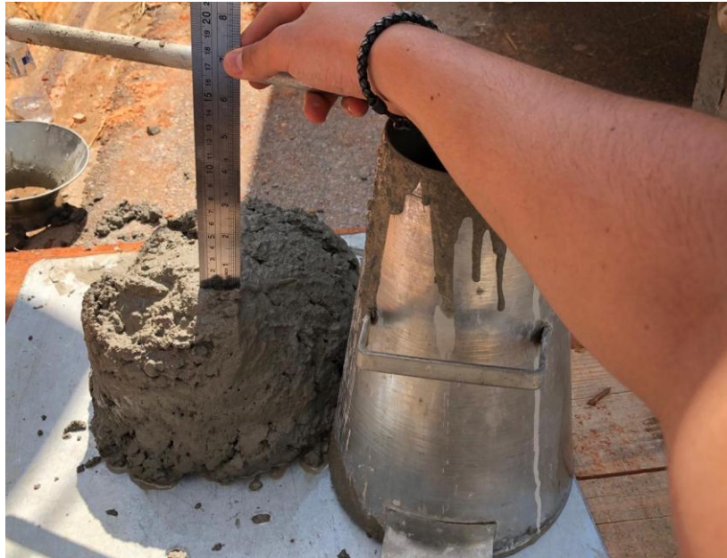
Figura 46: Resultado do Slump Test
