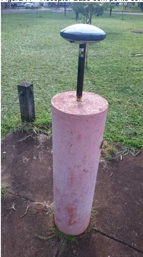
Figura 77 - Receptor Base com ponto conhecido (UFLA)
