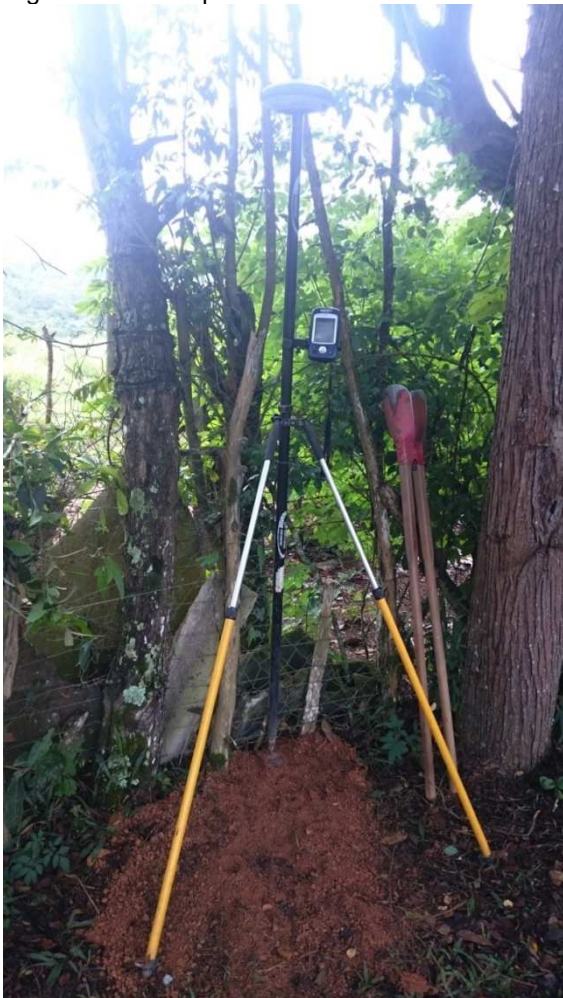
Figura 84 - Receptor Rover coletando dados no marco 1810
