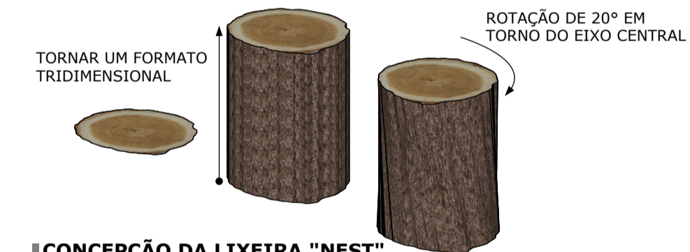
CONCEPÇÃO DA LIXEIRA "NEST" PERSPECTIVA MATERIAL: POLIETILENO DE ALTA DENSIDADE ESCALA.: 1/25
