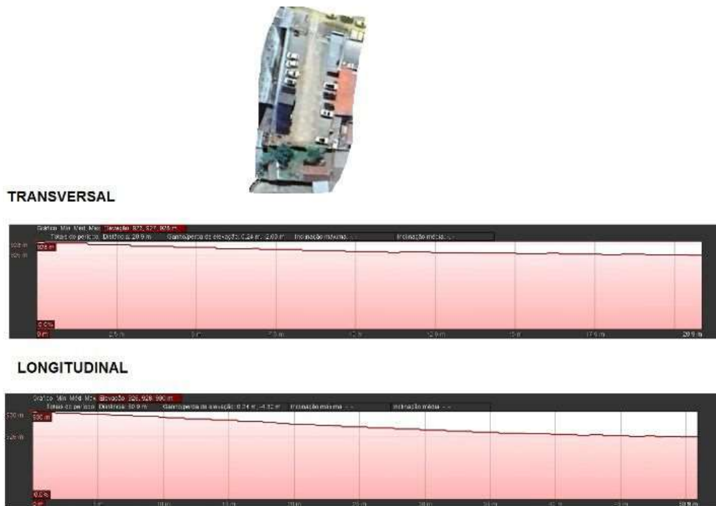
Figura 16 - Corte Topografia do Terreno
