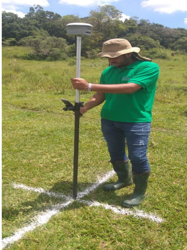
Figura 6 - Coleta da coordenada do ponto de controle
