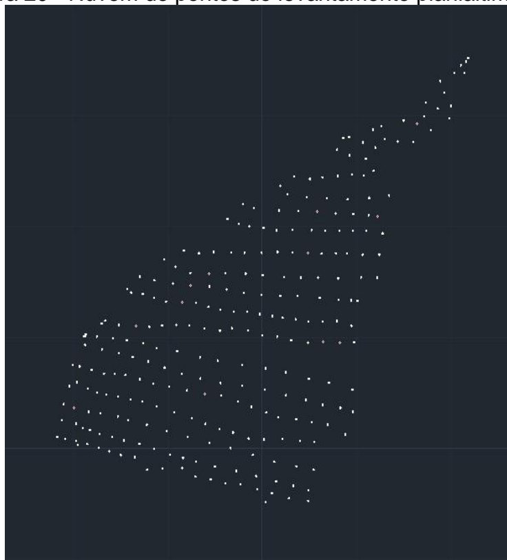
Figura 20 - Nuvem de pontos do levantamento planialtimétrico
