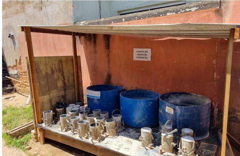
Figura 56: Abrigo e recipientes para cura dos corpos de prova.
