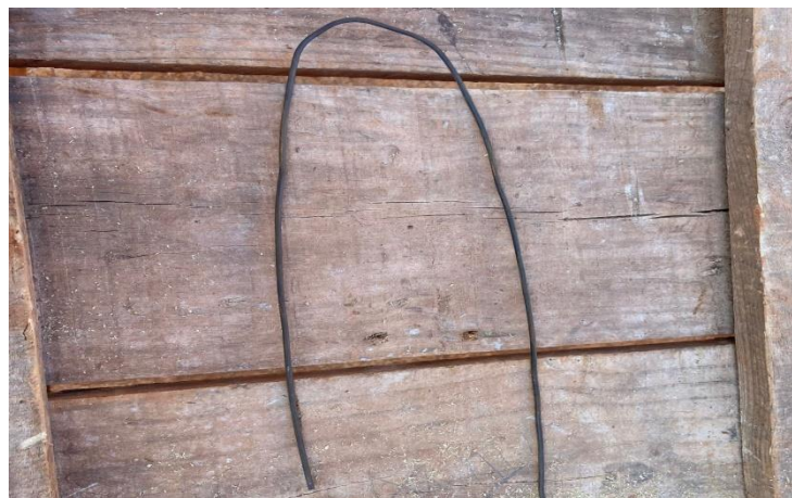
Figura 69: Arame utilizado para amarração das formas
