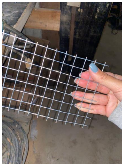
Figura 25 – Tela de alvenaria
