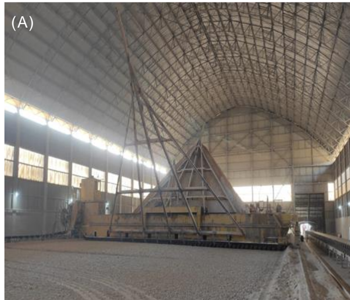
Figura 19. (A) Retomadora de Calcário 131RE01. (B) Pilha II de Calcário Mina Sul, cada pilha tem em média 23 a 25 mil toneladas de Calcário.
