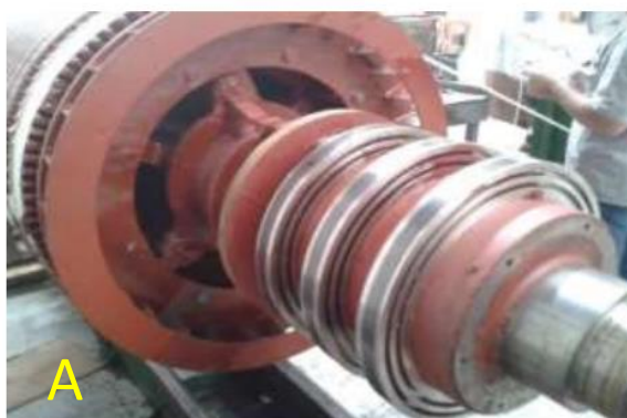
Figura 03 - Sistema de anéis e escovas de motor de 6,6kVAC, 3.200 KW
