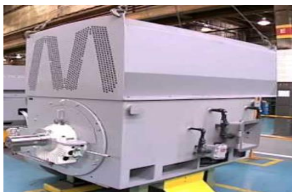
Figura 02 - Motor de Indução trifásico 6,6 KV 7.300KW
