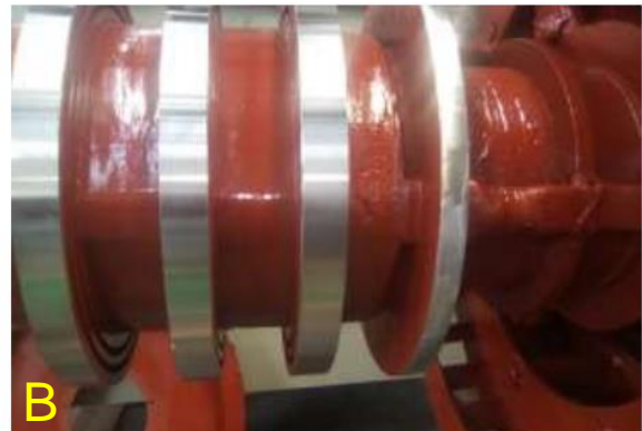
Figura 03 - Sistema de anéis e escovas de motor de 6,6kVAC, 3.200 KW
