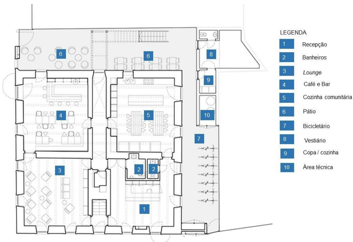
Figura 1 - Planta baixa do pavimento térreo
