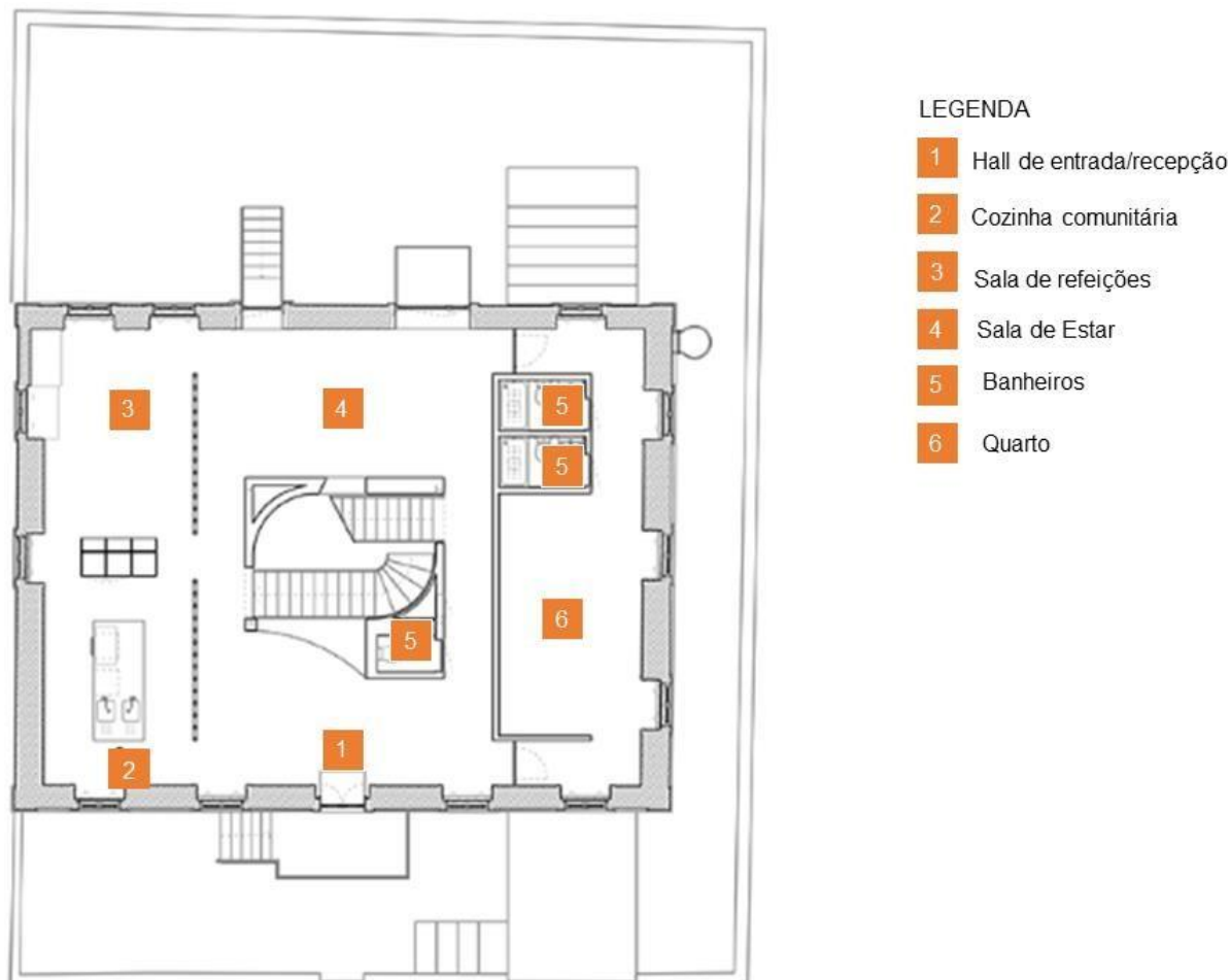
Figura 7 - Planta baixa do pavimento térreo
