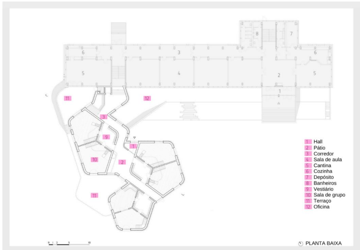
Figura 3 - Planta baixa, pavimento térreo da nova extensão
