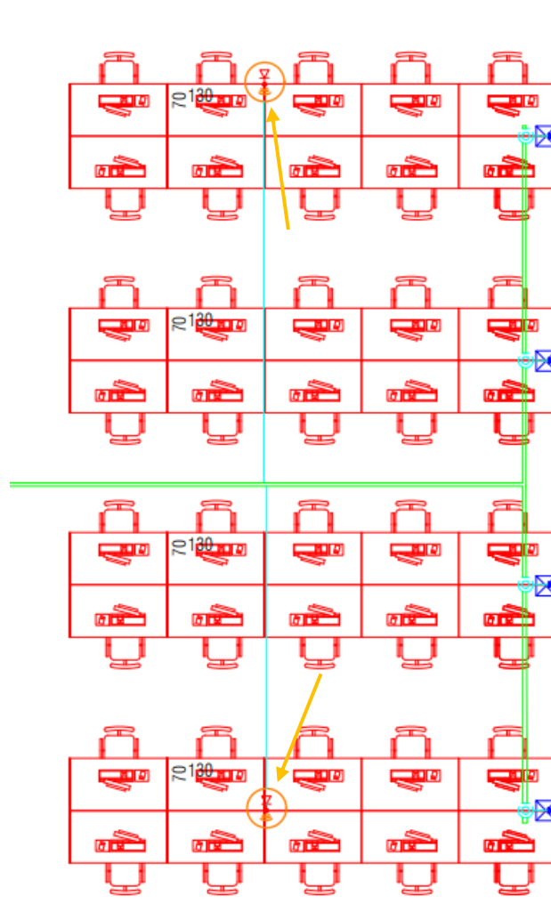
Figura 95 - Disposição dos roteadores.
