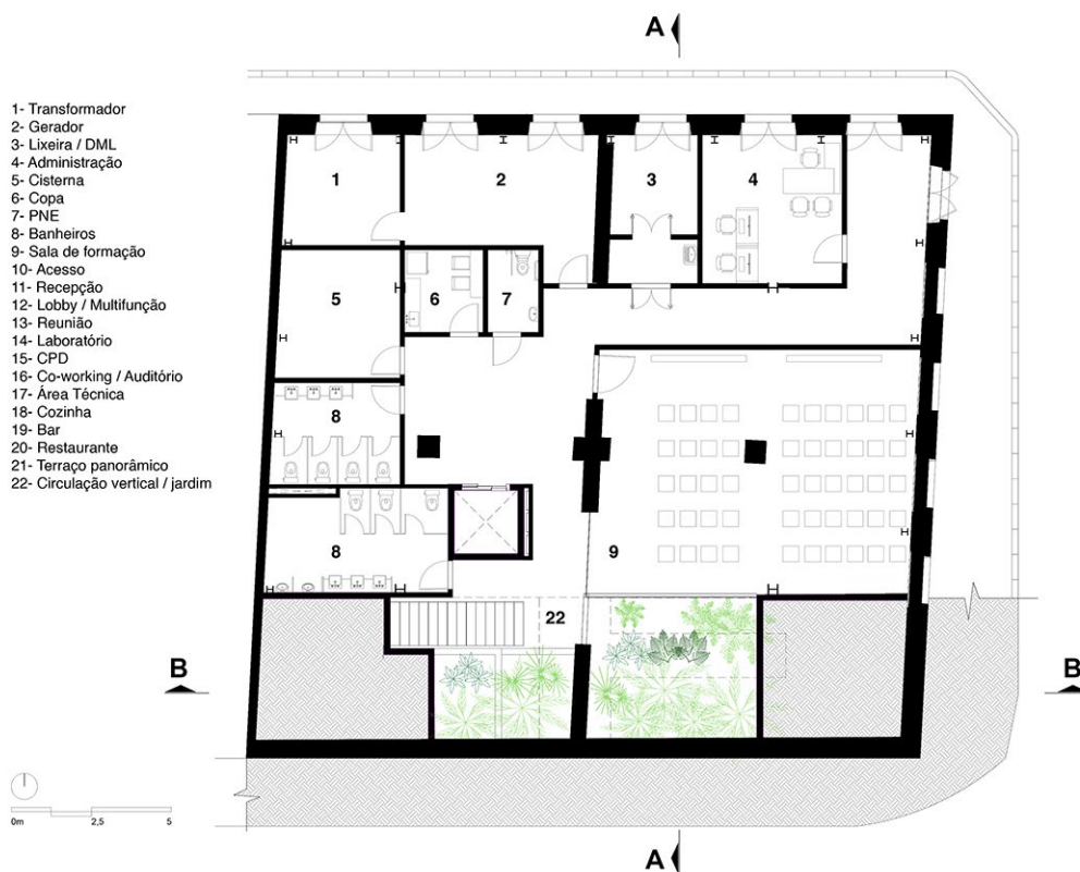
Figura 6 – Planta Pavimento Subsolo
