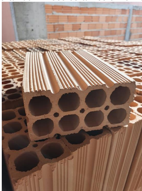
Figura 100 – Bloco cerâmico 9x19x29 cm
