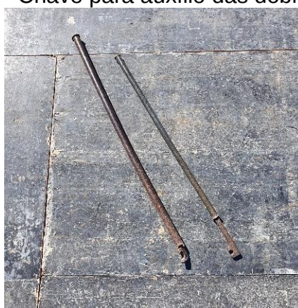
Figura 57 – Chave para auxílio das dobras de aços
