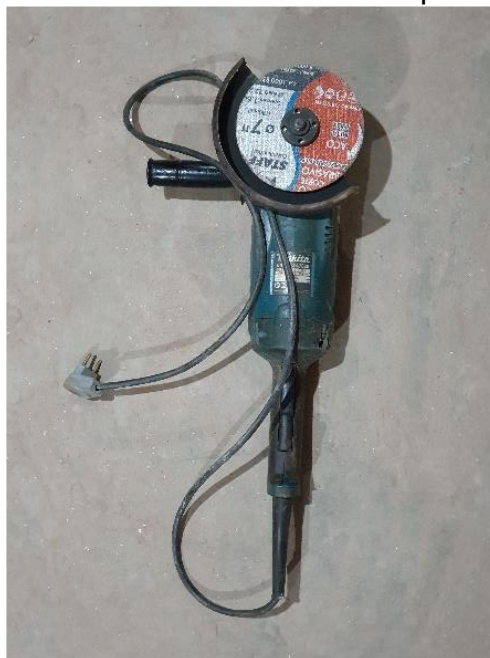
Figura 53 – Esmerilhadeira – ferramenta para corte do aço
