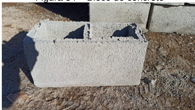
Figura 34 – Bloco de concreto
