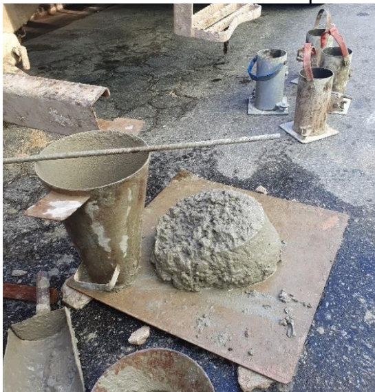
Figura 75 – Posicionamento do cone para medição
