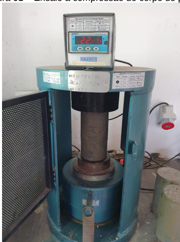
Figura 91 – Ensaio à compressão do corpo de prova
