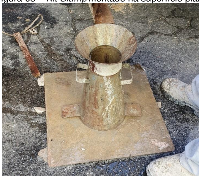
Figura 68 – Kit Slump montado na superfície plana
