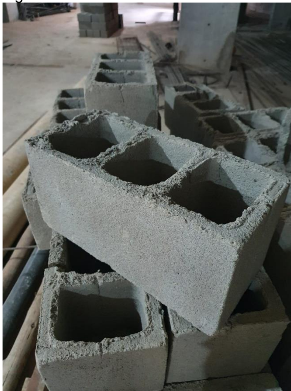
Figura 102 – Bloco concreto 9x19x39 cm
