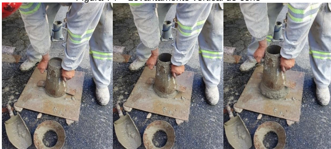
Figura 74 – Levantamento vertical do cone
