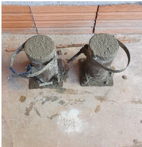
Figura 79 – Amostra de concreto dentro do molde de aço
