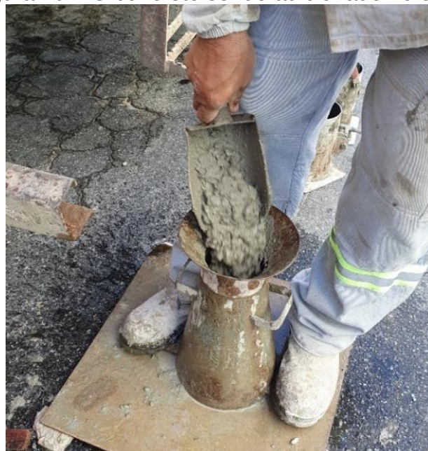
Figura 70 – O concreto sendo adicionado no cone
