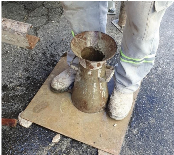
Figura 69 – Cone sendo firmado com os pés para receber o concreto
