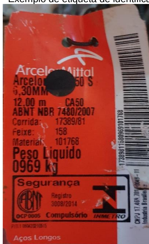
Figura 50 – Exemplo de etiqueta de identificação de aço
