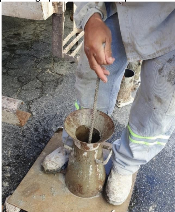
Figura 71 – Aplicação dos golpes com a haste para adensamento do concreto
