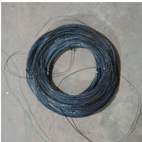
Figura 58 – Arame recozido nº 18 para amarração da armadura
