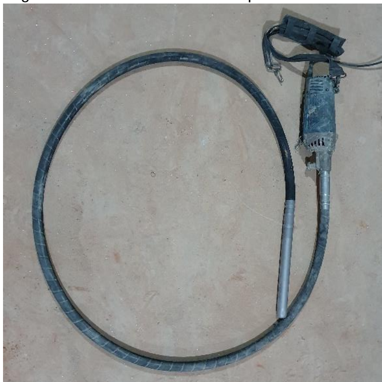
Figura 77 – Vibrador de concreto para adensamento
