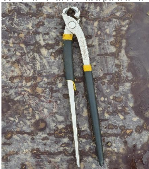
Figura 59 – Torques: ferramenta utilizada para amarração da armadura
