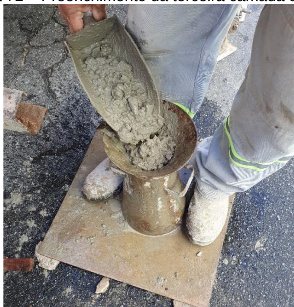
Figura 72 – Preenchimento da terceira camada do cone
