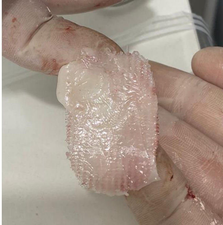
Figura 3: Tela protésica de polipropileno após aplicação de resina universal microhíbrida.
