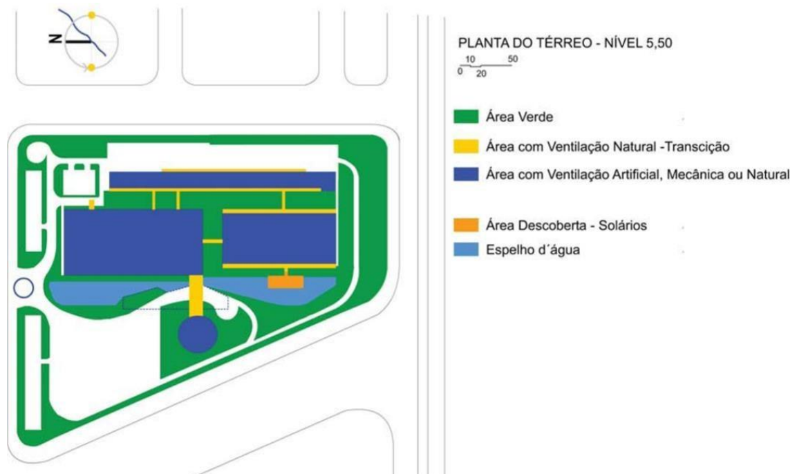
Figura 12: Tipos de ventilação utilizada em cada ambiente.
